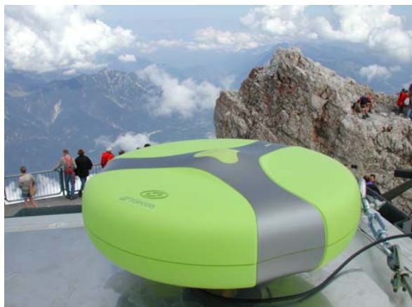
Abbildung 7 GPS-Empfänger auf der Zugspitze zur Bestimmung des Atmosphärischen Wasserdampf-Säulengehalts.
