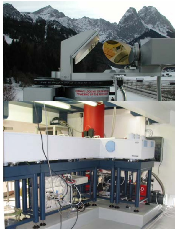
Abbildung 2 Neu implementiertes Infrarot-Radiometer am Standort Garmisch zur Erfassung troposphärischer Spurengas-Höhenverteilungen.
